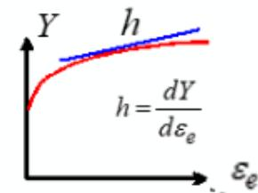
$$\sigma_e = \sqrt{\frac{3}{2} S_{ij} S_{\bar{j}}} = \sqrt{\frac{1}{2} \left[ (\sigma_1 - \sigma_2)^2 + (\sigma_1 - \sigma_3)^2 + (\sigma_2 - \sigma_3)^2 \right]} \quad S_{ij} = \sigma_{ij} - \frac{1}{3} \sigma_{kk} \delta_{ij}$$
